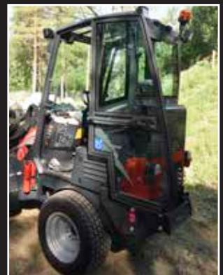
Kabinentür, in geöffneter Position verriegelt
