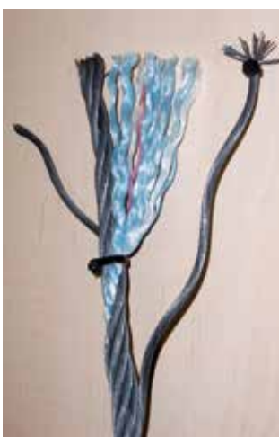
Bild 8-2: Aufbau eines Litzenseiles
