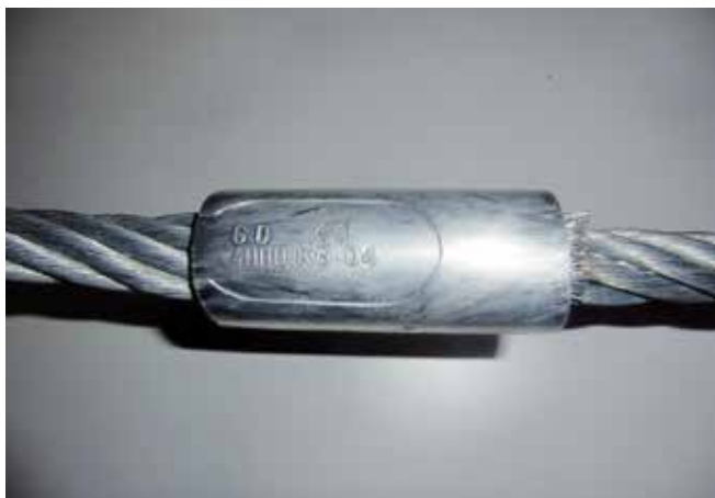
Bild 9-1: Pressklemme mit Verpresserkennzeichen
