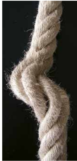
Bild 23-8: Durch Klanke zerstörter Litzenverbund
