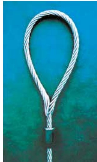
Bild 9-7: Die beiden Enden sind gegeneinander verseilt
