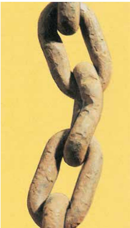
Bild 23-10: Kette mit verbogenem und eingekerbtem Kettenglied
