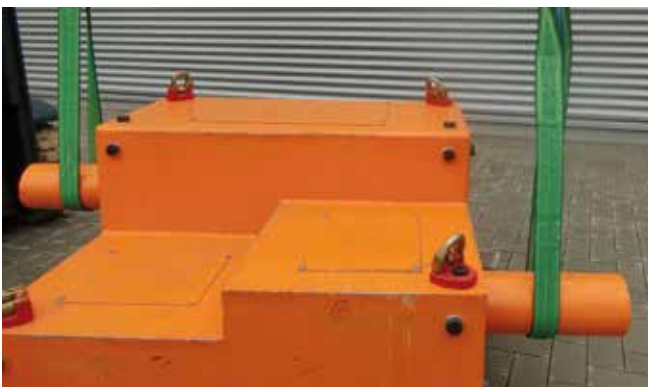
Bild 6-2: Hebebänder sind oberflächenschonend
