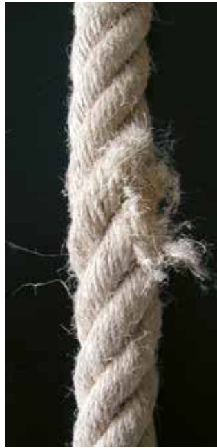
Bild 23-7: Zerstörung einer Litze
