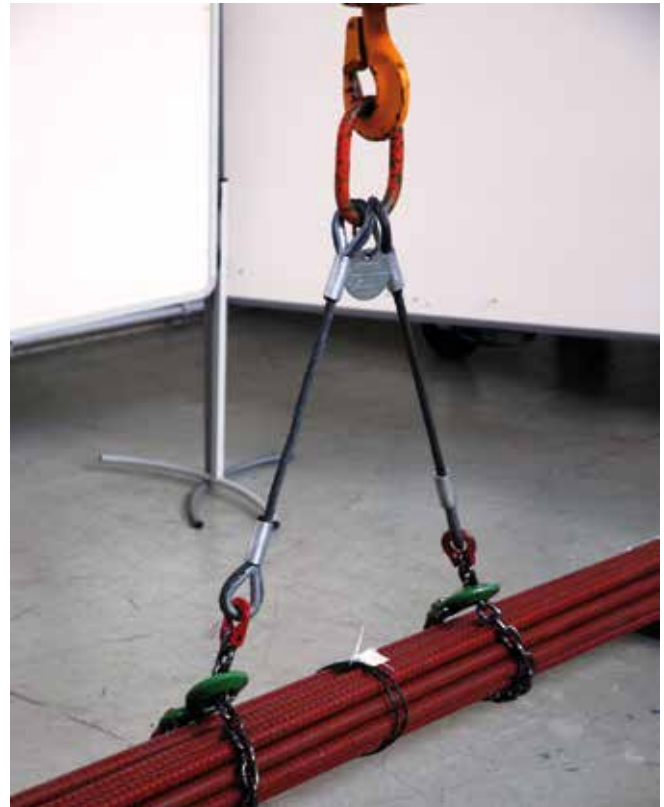
Bild 6-1: Kombination Seil/Kette zur Schonung der Drahtseile
