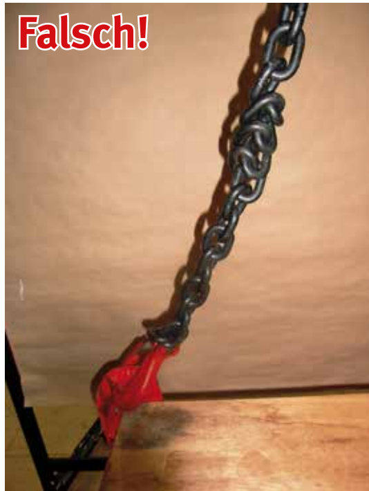
Bild 22-4: Stark verdrehte Kette. Beim Anheben der Last wird die Kette so beschädigt, dass sie nicht mehr weiter verwendet werden darf
