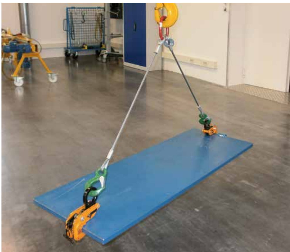
Bild 13-1: Blech horizontal sicher transportiert
