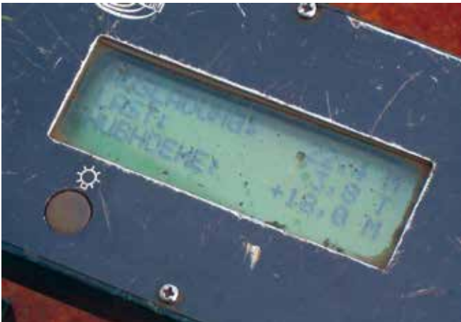
Bild 5-3: Steuerbirne mit digitaler Lastanzeige
