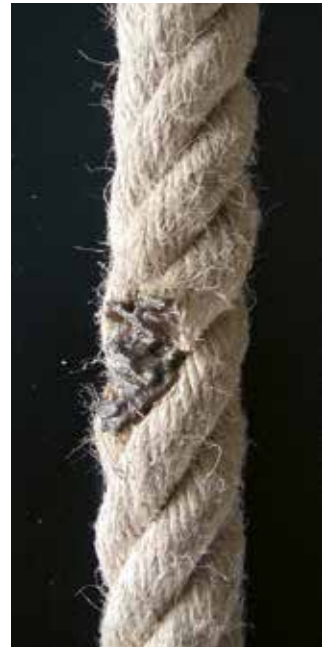
Bild 23-9: Wärmeeinfluss hat eine Litze zerstört
