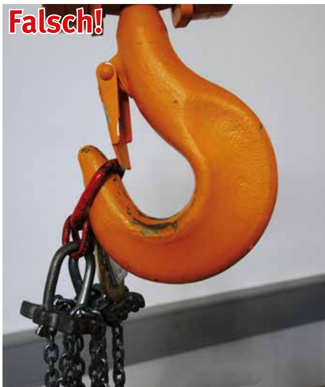
Bild 22-1: Das Aufhängeglied ist für den Kranhaken zu klein. Es wird aufgeweitet und verbogen.
