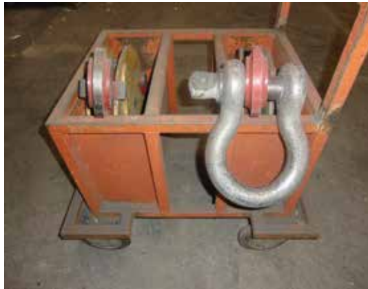
Bild 24-2: Abgestellte, gegen Umfallen gesicherte Lastaufnahmemittel
