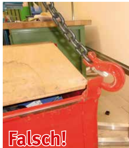
Bild 16-4: Haken rutschen bei Schlaffketten aus den Ösen
