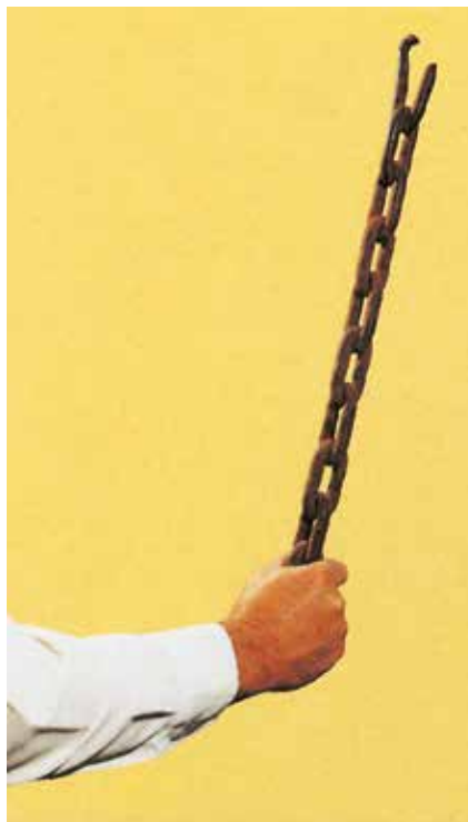
Bild 23-11: Durch Überlastung steif gezogene Kette
