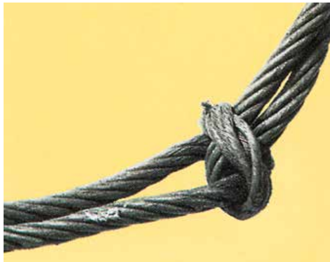
Bild 9-2: Unzulässiger Knoten zerstört den Seilverbund
