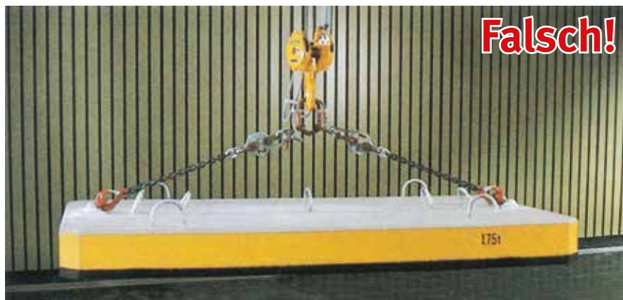
Bild 14-2: Demonstrationslast mit Messelementen im Haken mit bis zu vier Kettensträngen. Bei diesem unzulässig hohen Neigungswinkel übersteigt die Kraft in jedem Einzelstrang das Gewicht der Last!
