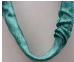
Bild 23-16: Durch Wärmeeinfluss zerstörte Ummantelung; Ablegereife auch wegen Sichtbarkeit der Einlage erreicht
