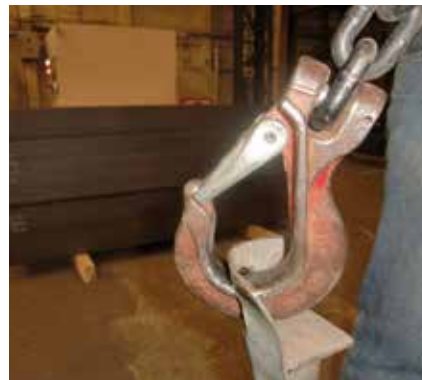
Bild 16-3: Haken von innen nach außen stecken. Noch besser ist: Haken mit Sicherung verwenden
