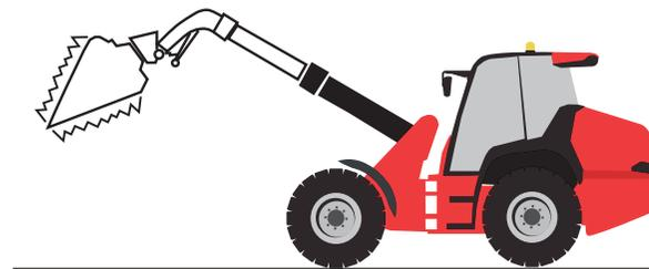
2 - **Schaufelfunktion «Bucket Shaker»**: Ermöglicht schnelles Entleeren der Schaufel, ohne sich wiederholende Bewegungen ausführen zu müssen. Das Gut bleibt nicht mehr in der Schaufel kleben.
